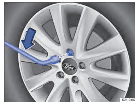
Рис. 213 Заміна колеса: відкручування болтів кріплення колеса
