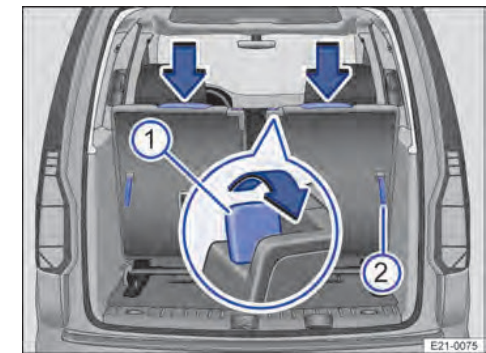
Рис. 72 Третій ряд сидінь: складання спинки вперед.
