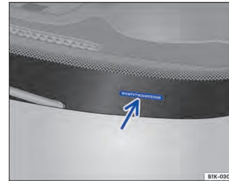
Рис. 227 На вітровому склі: ідентифікаційний номер автомобіля.
