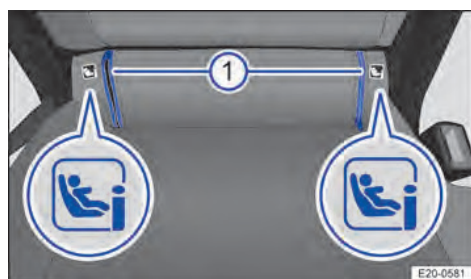
Рис. 41 На сидінні автомобіля другого ряду: варіанти маркування, що позначають точки кріплення ISOFIX для дитячих крісел.
