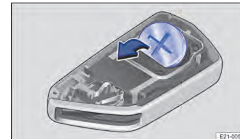
Рис. 54 Ключ від автомобіля: заміна елемента живлення.
