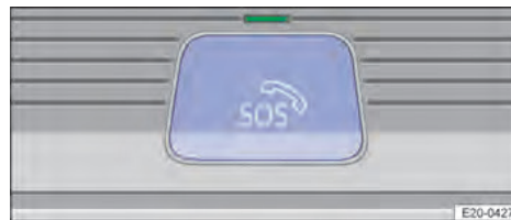
Рис. 49 На стільовій консолі: керування аварійною системою eCall (за кришкою кнопки).
