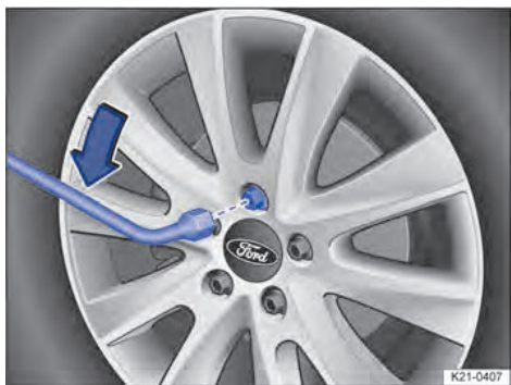
Рис. 218 Заміна колеса: Відкрутіть болти кріплення колеса за допомогою колісного ключа.
