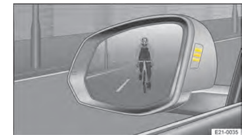
Рис. 124 У корпусах зовнішніх дзеркал: візуальні індикатори системи оповіщення під час виходу з автомобіля
