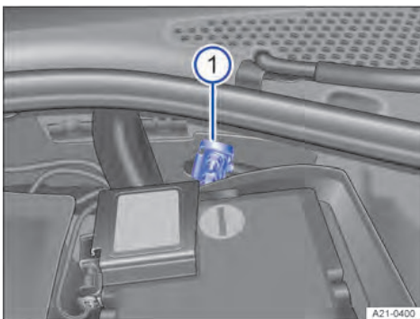
Рис. 185 У відсіку двигуна: Точка під'єднання для запуску від зовнішнього джерела (заземлення).
