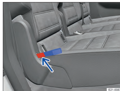
Рис. 66 Другий ряд сидінь: позначка, що вказує на те, що спинка сидіння не зафіксована належним чином.
