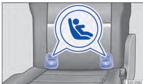
Рис. 42 На сидінні автомобіля третього ряду: варіанти маркування, що позначають точки кріплення ISOFIX для дитячих крісел.
