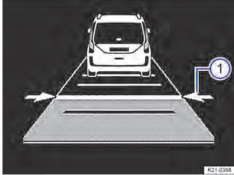
Рис. 115 На дисплеї аналогової приладової панелі: встановлена відстань 1, адаптивний круїз-контроль керує автомобілем (рисунок).
