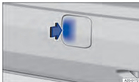
Рис. 187 У задньому бампері праворуч: демонтаж кришки.
