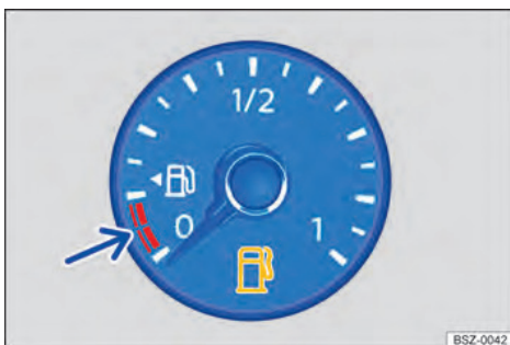
Рис. 16 Показчик рівня пального на аналоговій приладовій панелі (рисунок).
