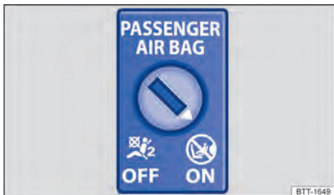
Рис. 32 На передній частині приладової панелі: перемикач із ключем для увімкнення та вимкнення фронтальної подушки безпеки переднього пасажиря
