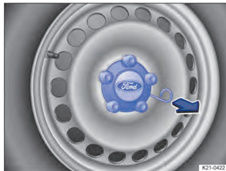
Рис. 210 Демонтаж центральних ковпачків.
