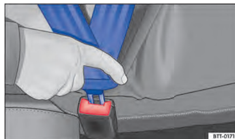
Рис. 23 Вставлення язичка застібки ременя безпеки в пряжку.
