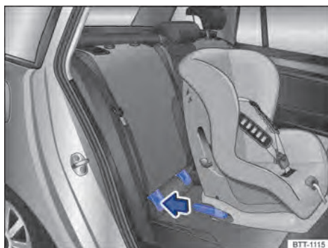
Рис. 43 Рисунок: встановлення дитячого крісла ISOFIX за допомогою кріпильних кронштейнів.
