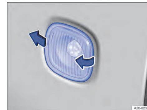
Рис. 176 На бічній панелі автомобіля: демонтаж повторювача покажчика повороту.
