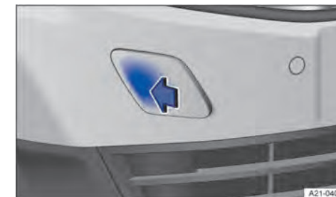
Рис. 189 У передньому бампері праворуч: демонтаж кришки.
